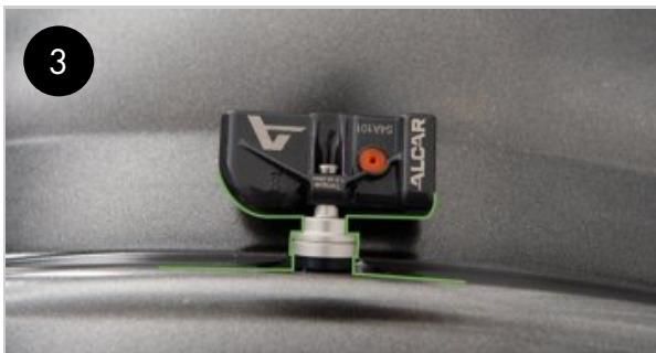
3 Nutná minimální vzdálenost mezi čelem snímače a ráfkem.
